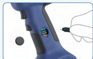
La connectique USB permet d'accéder aux données de l'outil grâce au logiciel CT Diag.
