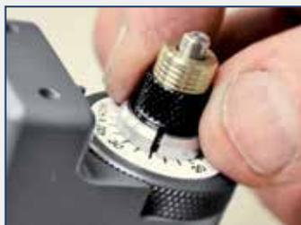
La profondeur de la lame est facilement réglable en tournant le cadran.
