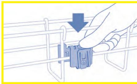
Appliquer une pression verticale jusqu'au verrouillage en butée.
