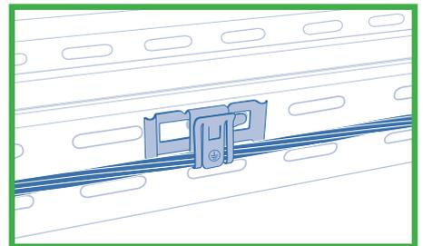
Insertion de la câblette cuivre et verrouillage en butée.
