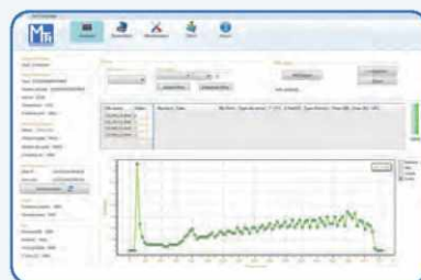
Mittels der Software kann das Werkzeug konfiguriert, die Crimpdaten ausgelesen und die Presszyklen analysiert werden.
