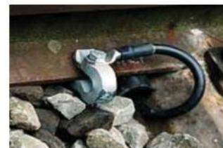
Mit dieser Kontaktklemme ist das Problem der losen Anschlüsse hinfällig, denn sie "beisst" sich aufgrund ihrer speziellen Konstruktion an der Schiene fest und stellt auf diese Weise schnell und einfach einen hundertprozentigen elektrischen Kontakt für Signal- wie auch für Rückströme her.
