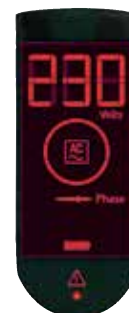
Exemple de détection de tension alternative de 230 V, affichage en ROUGE
