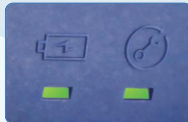
Mehrfarbige LED's informieren über den Ladezustand der Akkus und den Arbeits- und Servicezustand des Werkzeuges.
